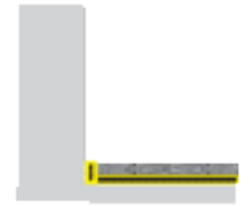
Sous-chouche pour bruits d'impact : parquet flottant (L= 23 dB)
